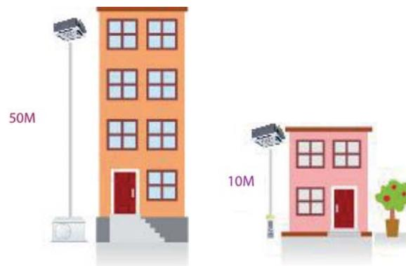
Максимальное расстояние между внутренним канальным блоком и наружным блоком может достигать 50 метров. Расстояние от внутреннего блока до проводного пульта управления - 10 метров .
